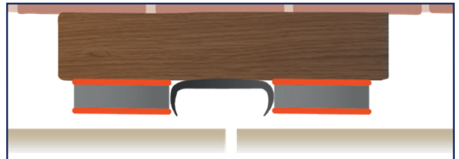
SECȚIUNE TRANSVERSALĂ SCHEMATICĂ (VEDERE DE SUS) A SISTEMULUI PAD BOSTIK: Gri: benzi. Crem: panouri pentru placarea fațadei ventilate. Roșu: adeziv de contact. Între șnururi și panouri este montat un profil format din garnituri de etanșare din cauciuc.
